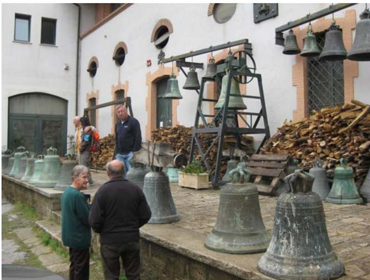
il s'agit alors d'airain, métal plus fragile, utilisé pour les sonneries de pendules ou autres morbières. Le creuset est en graphite, minéral qui doit supporter une température de 1100 degrés. La pureté de l'alliage donne le velouté du timbre ; les courbes, le diamètre et l'épaisseur de la cloche apportent la justesse de la note et son harmonie. Le cuivre, cher actuellement, provient de récupération alors que l'étain est acheté en lingots.
